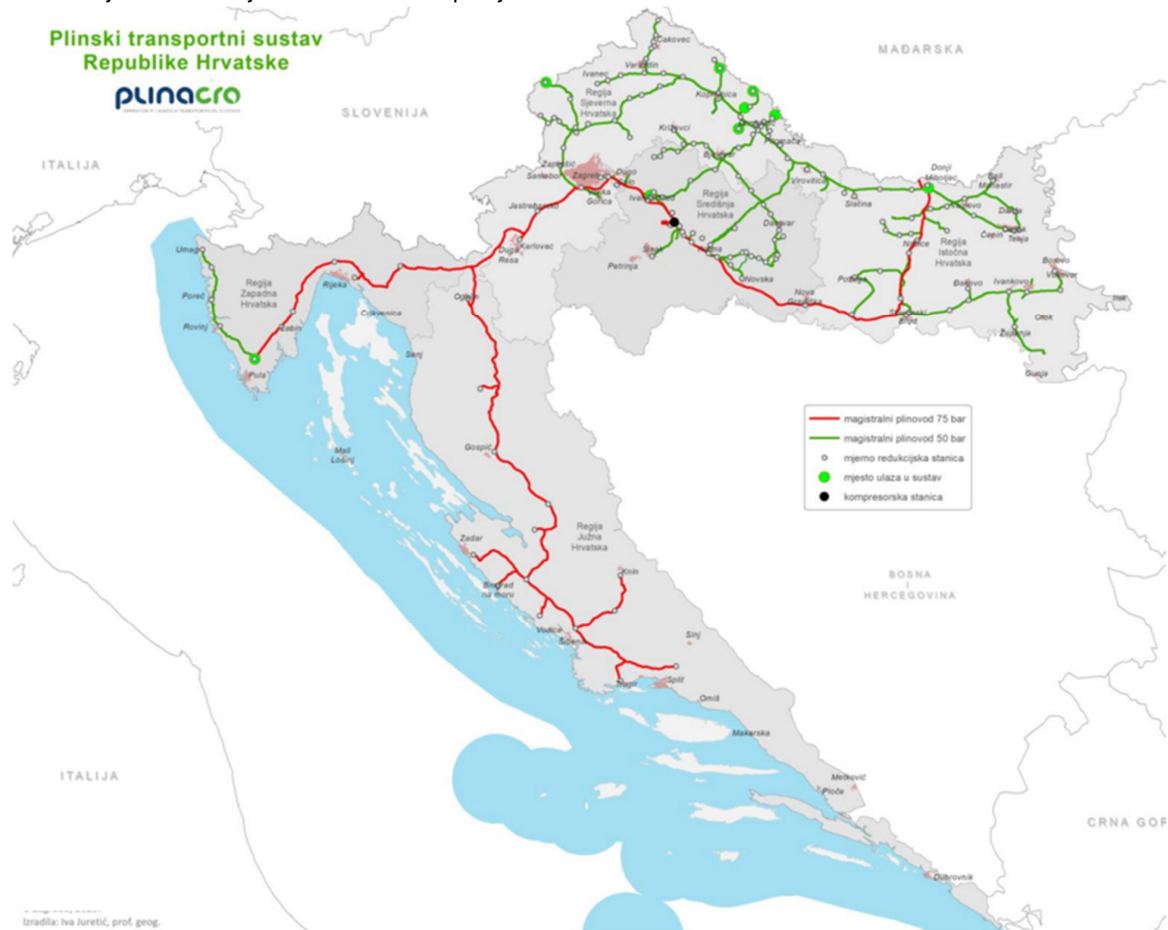
Slika 32. Plinski transportni sustav RH, stanje na dan 31. prosinca 2019. godine Izvor: PLINACRO, Desetogodišnji plan razvoja plinskog transportnog sustava RH 2021. – 2030.
