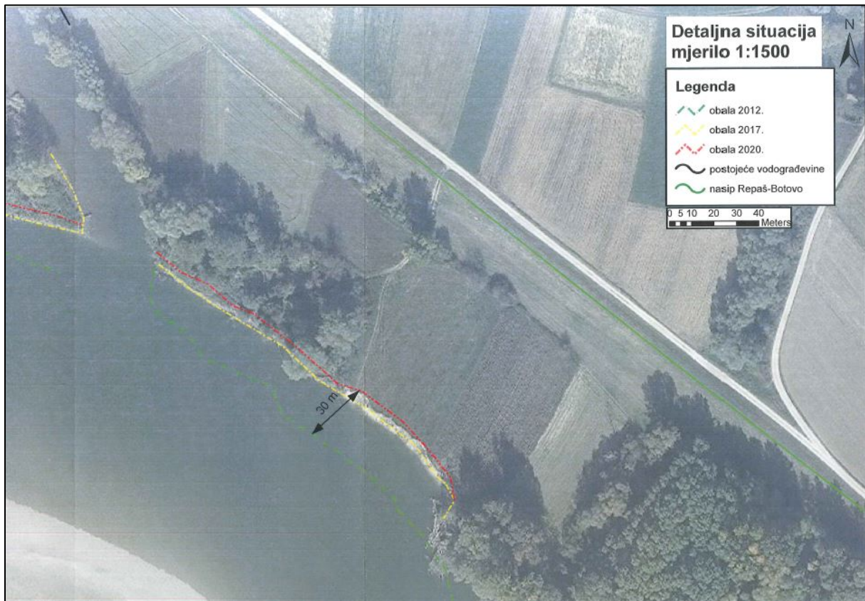
Slika 5. Napredovanje erozije – pomicanje linije obale od 2012. do 2020. godine (Hrvatske vode)
