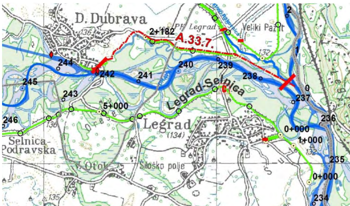
Slika 1.1.1.1. Provedbeni plan obrane od poplava, dionica A.33.7. – rijeka Drava – lijeva obala, rkm 236+700 - 243+000, ušće Mure u Dravu - restitucija HE Dubrava
