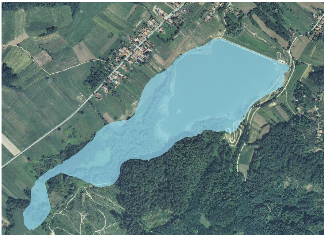
Grafički prikaz 3-11: 5 Doseg vode za razinu vode u akumulaciji identičnoj koti krune pregrade (H=161.3 m n. m.)
