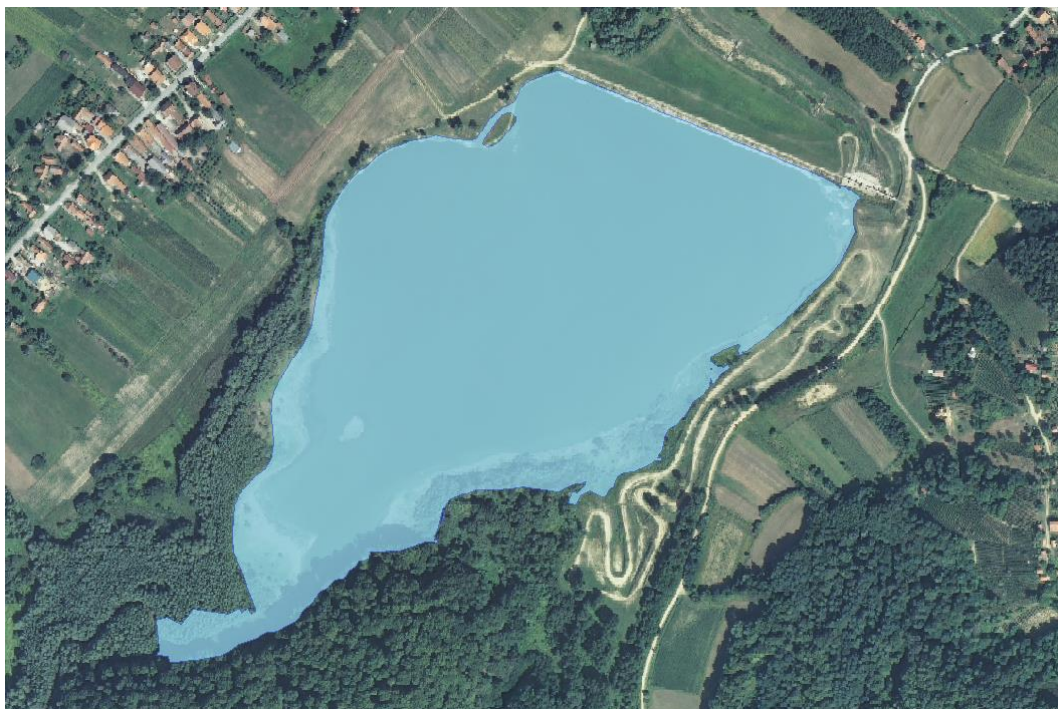
Grafički prikaz 3-10: Doseg vode za razinu vode u akumulaciji identičnoj razini preljeva (H=159.2 m n. m.)
