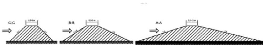
Slika 8. Shematski prikaz – poprečni presjek pera
