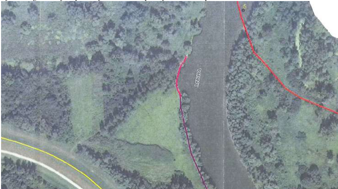
Slika 5. Situacija planiranog zahvata (rozo – planirana obaloutvrda, ljubičasto – postojeća obaloutvrda) na digitalnoj ortofoto karti (Izvor: Idejno rješenje, G. Martinez, Hrvatske vode)
