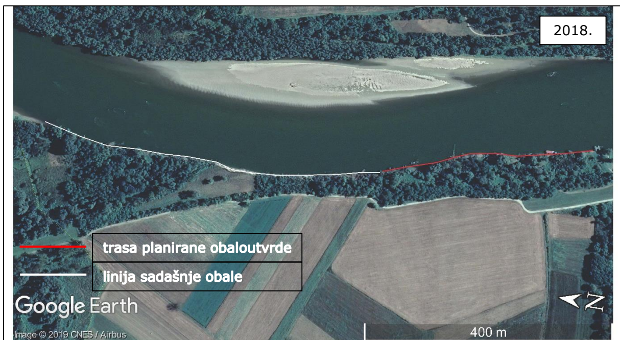
Slika 8. Napredovanje erozije na lokaciji zahvata u periodu 2015.-2018. (Google Earth)
