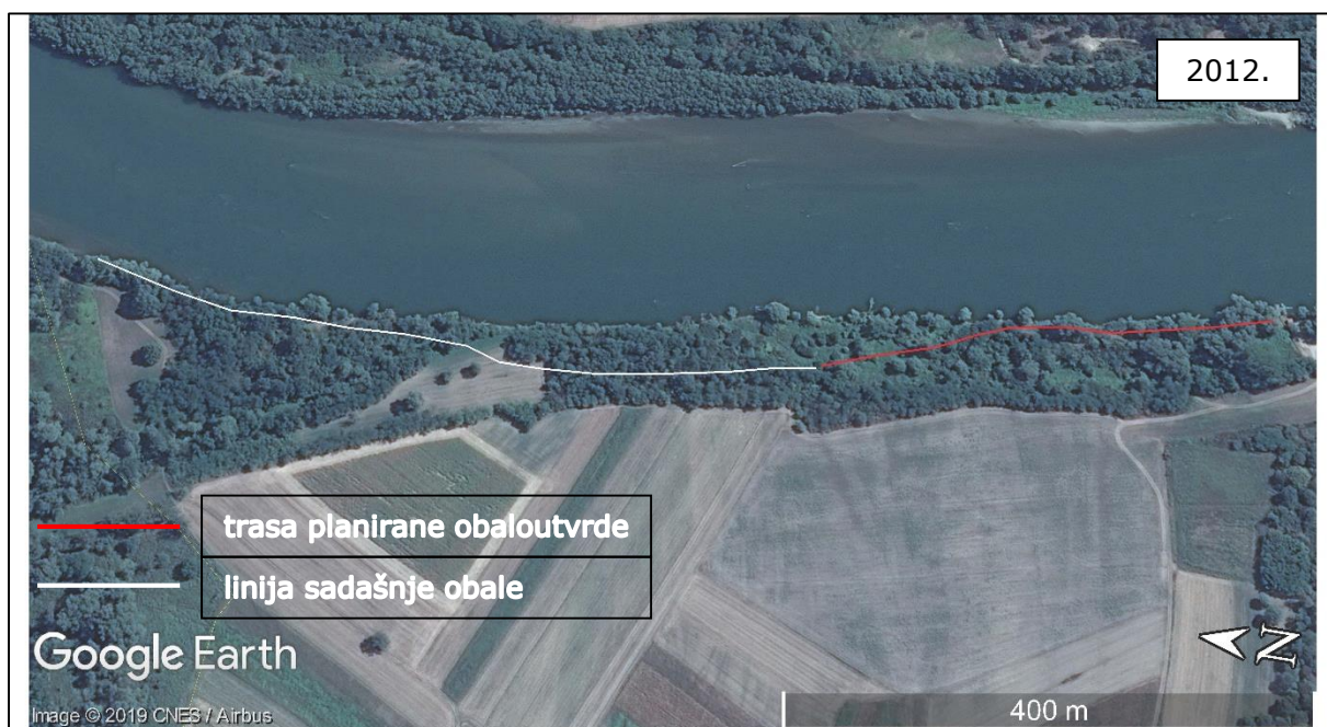
Slika 7. Napredovanje erozije na lokaciji zahvata u periodu 2006.-2012. (Google Earth)
