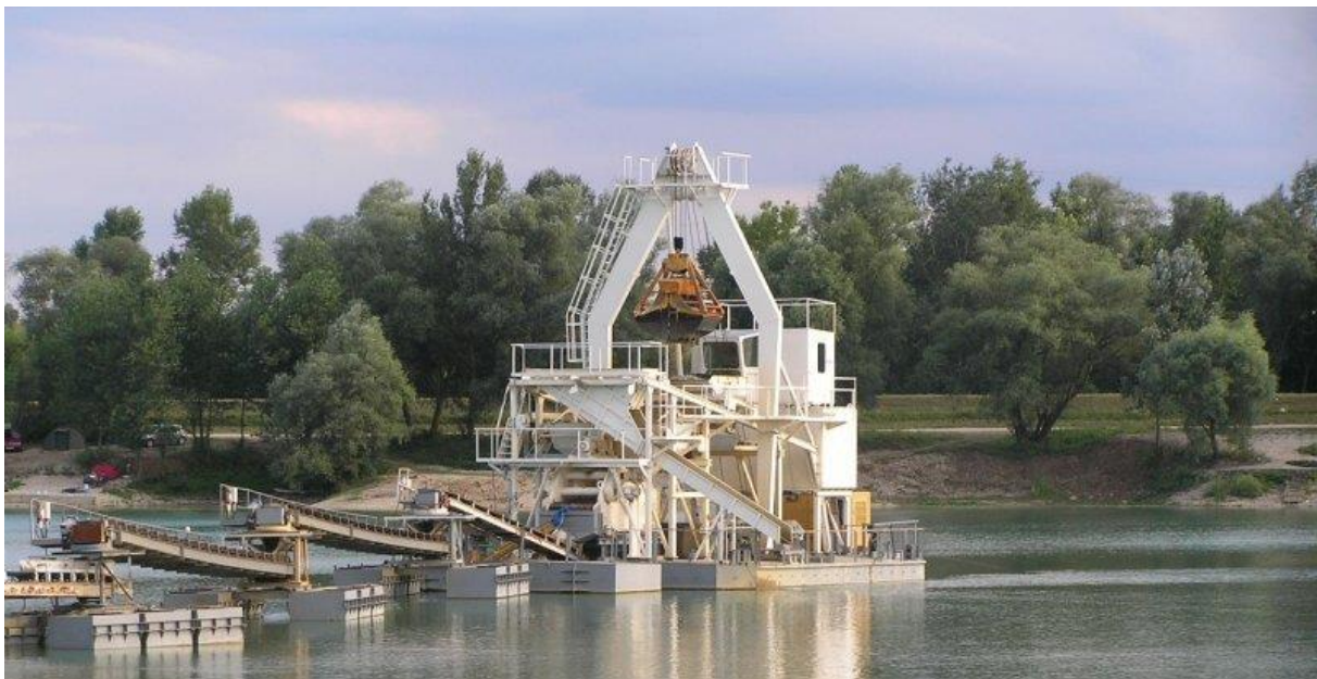
Slika 13. Primjer plovnog bagera s trakastim transporterima
