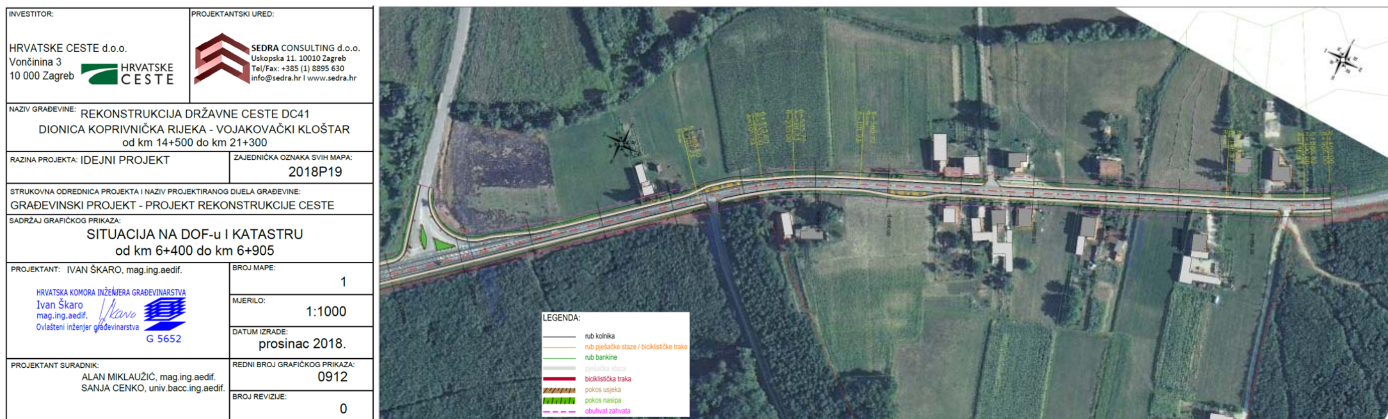
Slika 2.3-10. Situacija predmetne rekonstrukcije prometnice na DOF podlozi – završni dio trase od km 6+400 do km 6+905
