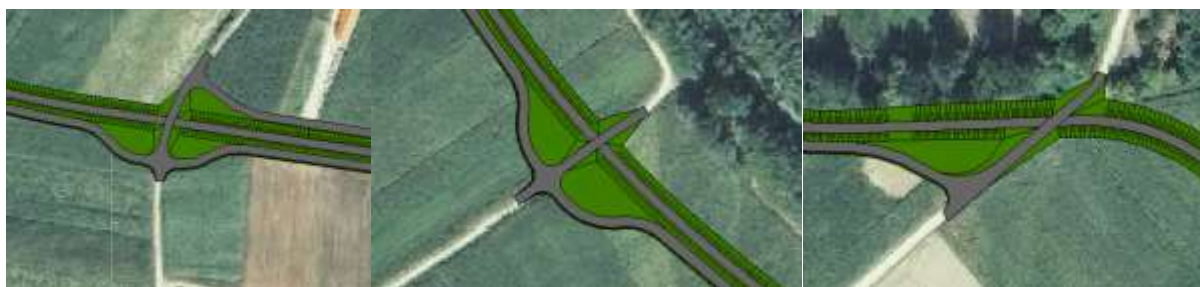
Slika 2.11 Prikaz projektiranih rampi
