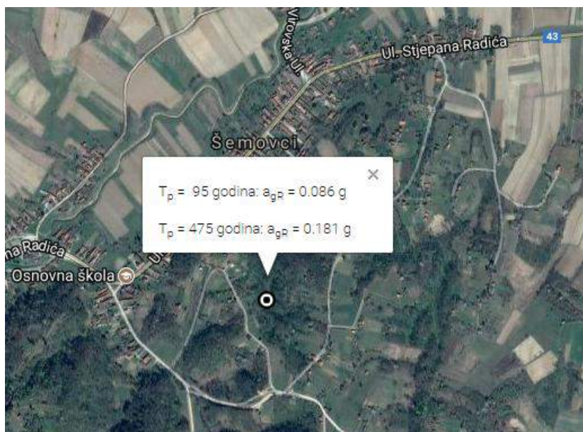
Slika 4.12. Horizontalna vršna ubrzanja tla tipa A ( a_{gR} ) za povratna razdoblja od T_p = 95 i 475 godina za područje zahvata (izvor: http://eizkarta.gfz.hr/karta.php )
