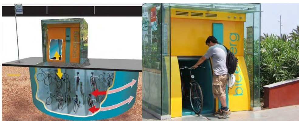
Slika 18.26. Biceberg sustav parkirališta Izvor: biceberg.com and thecityfix.com/
