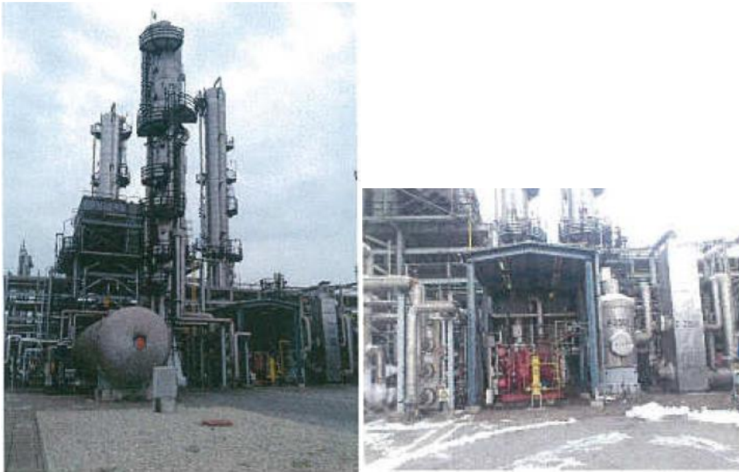
Slika 4.2.9. Postojeći demetanizer (a) i postojeći turboekspander (b)
