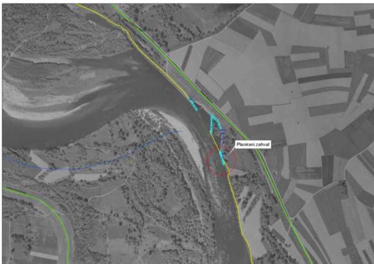
Slika 6. Situacija s ucrtanim zahvatom koji prikazuje odnos prema postojećim zahvatima, postojeći nasip (zeleno), postojeće vodnegrađevine iz Hidrografskog atlasa rijeke Drave snimljene 2000.g. (žuto), postojeće gradnje (svijetlo plavo), snimka obale iz V.mj. 2011. (tamno plavo), planirani predmetni zahvat ( u krugu – svijetloplavo), sve na DOF podlozi iz 2003.g.
