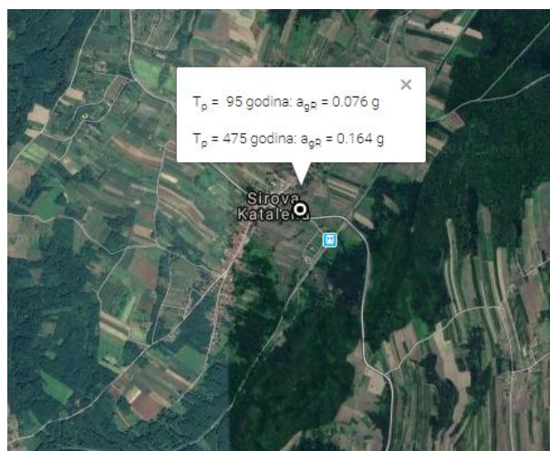
Slika 4.12. Horizontalna vršna ubrzanja tla tipa A (agR) za povratna razdoblja od T_p = 95 i 475 godina za područje zahvata (izvor: http://eizkarta.gfz.hr/karta.php )
