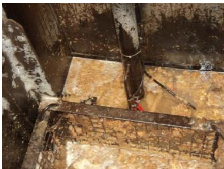
Slika 3.4. Prihvatna komora sa zaštitnom mrežicom i polipropilenske saće s kolonijama bakterija
