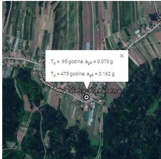
Slika 4.12. Horizontalna vršna ubrzanja tla tipa A ( a_{gR} ) za povratna razdoblja od T_p = 95 i 475 godina za područje zahvata (izvor: http://eizkarta.gfz.hr/karta.php )
